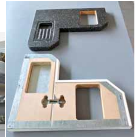
Oben: Freiformen werden später manuell bekantet, obwohl das BAZ dafür eingerichtet werden könnte. Bei Spezialaufgaben, wie etwa Lamellonut-Fräsen, kommen Adapter-Aggregate zum Einsatz. Auch Arbeitsplatten mit Oberflächen aus Mineralwerkstoff werden auf dem Homag-BAZ bearbeitet. Ausfräsungen für Verbindungselemente gehören zum Standard-Repertoire der Maschine
