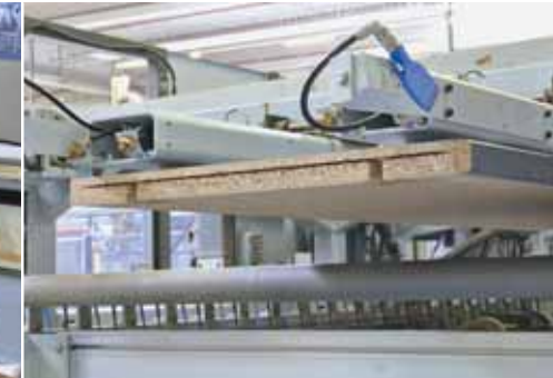
Oben: Freiformen werden später manuell bekantet, obwohl das BAZ dafür eingerichtet werden könnte. Bei Spezialaufgaben, wie etwa Lamellonut-Fräsen, kommen Adapter-Aggregate zum Einsatz. Auch Arbeitsplatten mit Oberflächen aus Mineralwerkstoff werden auf dem Homag-BAZ bearbeitet. Ausfräsungen für Verbindungselemente gehören zum Standard-Repertoire der Maschine
