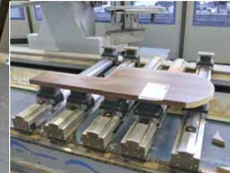
Oben: Freiformen werden später manuell bekantet, obwohl das BAZ dafür eingerichtet werden könnte. Bei Spezialaufgaben, wie etwa Lamellonut-Fräsen, kommen Adapter-Aggregate zum Einsatz. Auch Arbeitsplatten mit Oberflächen aus Mineralwerkstoff werden auf dem Homag-BAZ bearbeitet. Ausfräsungen für Verbindungselemente gehören zum Standard-Repertoire der Maschine
