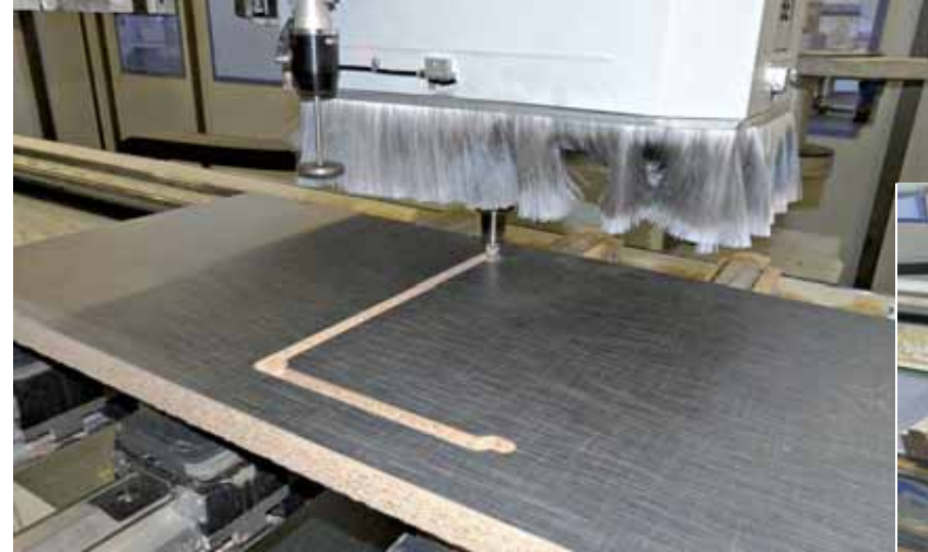
Links: Fertigungsleiter Gregor Sanne macht am Beispiel eines Auftrags deutlich, dass Losgröße Eins bei Westag & Getalit schon normal ist. Oben: Zu den üblichen Bearbeitungen zählt auch das Ausfräsen von Spülen- oder Herdausschnitten
