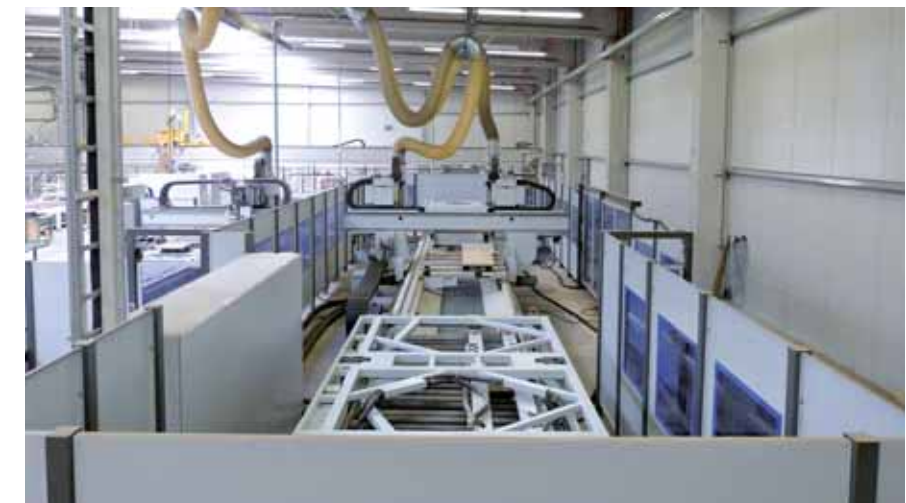
Jeweils am Ein- und Auslauf der Maschine werden die Arbeitsplatten mittels Transportshuttle ein- bzw. ausgeschleust. Im mittleren Teil findet die eigentliche Bearbeitung durch das Homag-BAZ in Fahrportal-Ausführung statt
