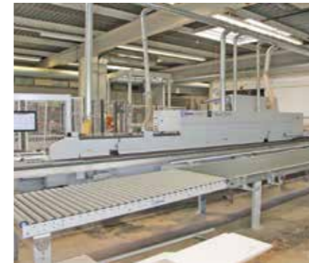
Frei bestückbar, rationell und material-unabhängig einsetzbar. Flexible Kanten-anleimmaschine HOMAG KAL 370.
