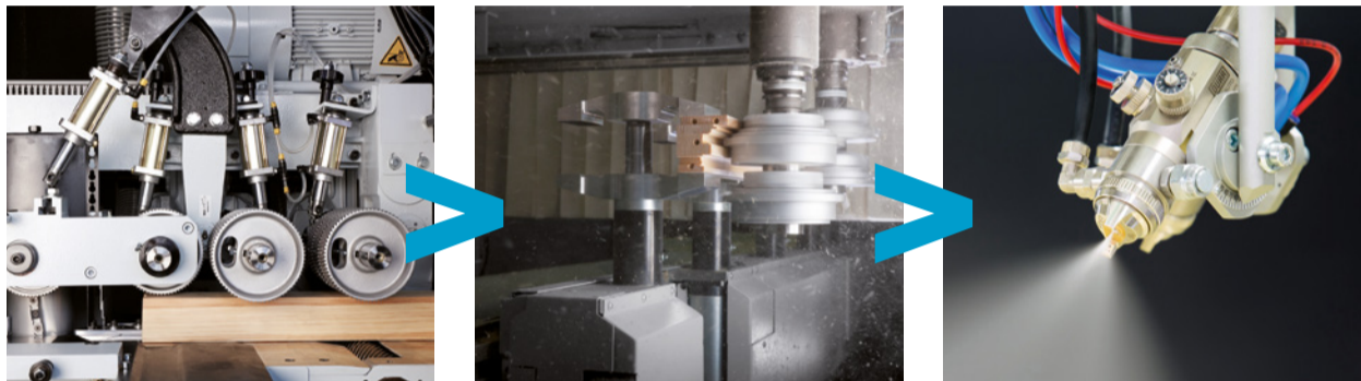
El trío ideal para la fabricación de ventanas: Cepilladora, máquina versátil de CNC y máquina de pintura
