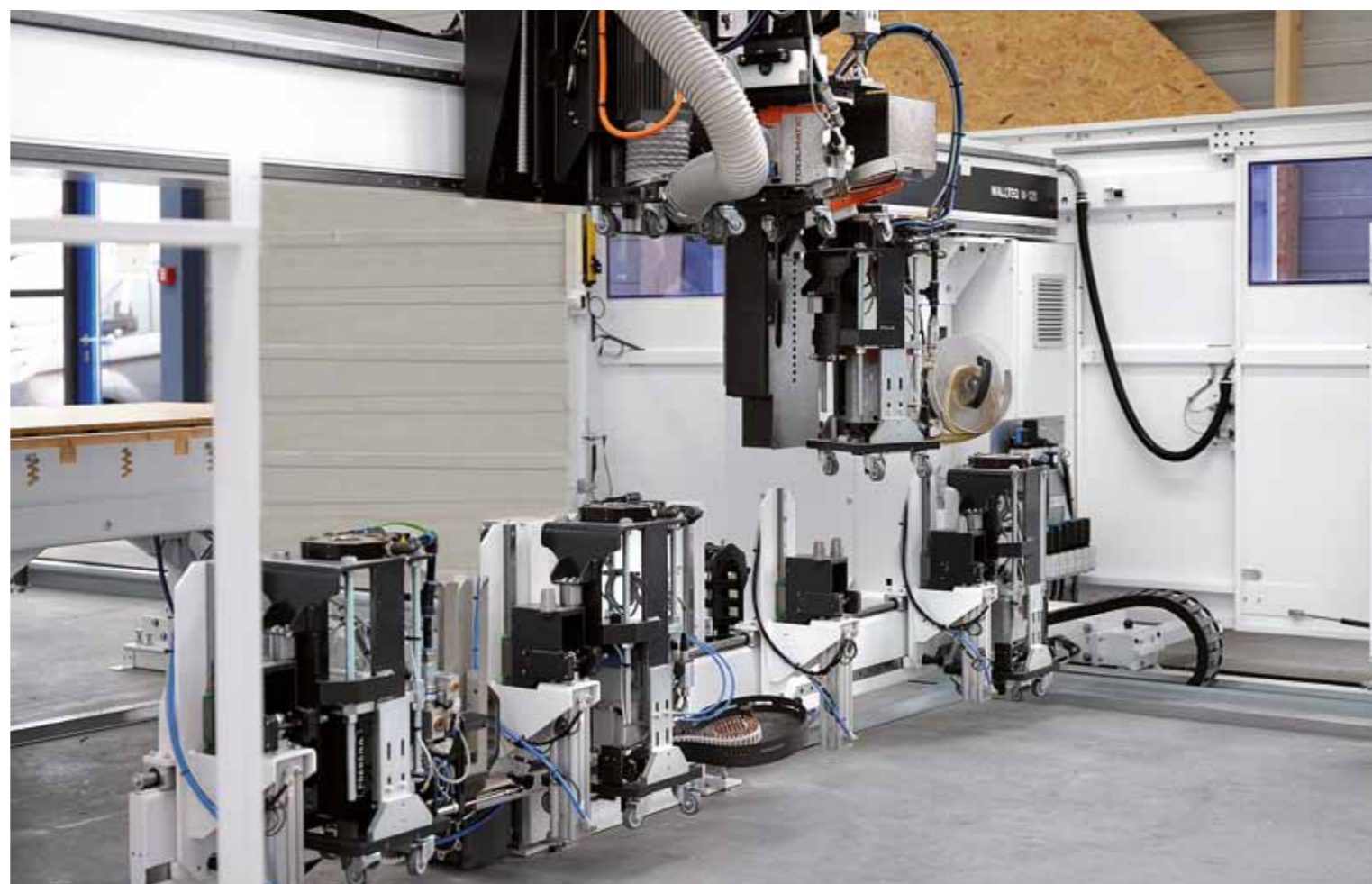
Bild: Das zum Patent angemeldete, vollautomatische Wechselsystem für Befestigungsgeräte an Multifunktionsbrücken.
