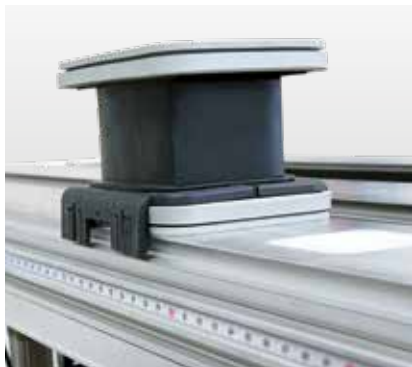
Cinta métrica para colocar las ventosas
