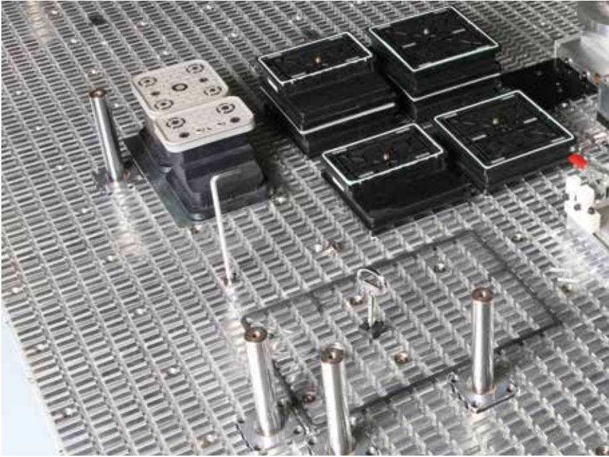
Fijadores de vacío: elementos de sujeción de vacío para instalar en las ranuras de la mesa tramada
