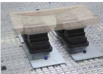
Sistema Maxi-Flex: placa base del sistema totalmente configurable de los fijadores de vacío
