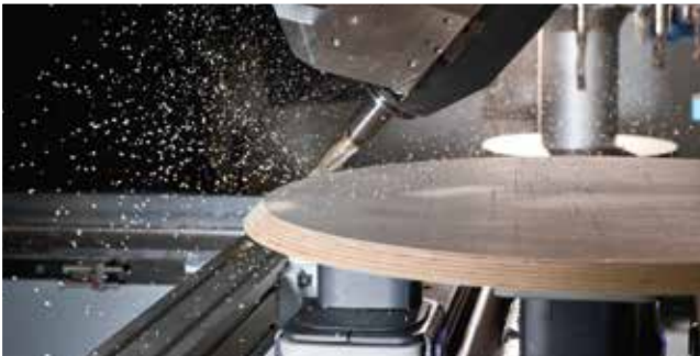
Fresado del bisel en un tablero de mesa
