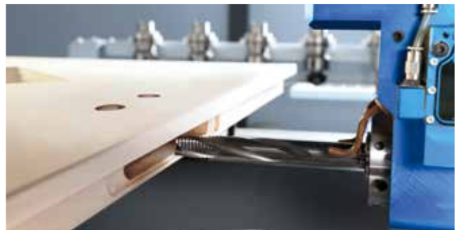
Fresado de la caja de cerradura
