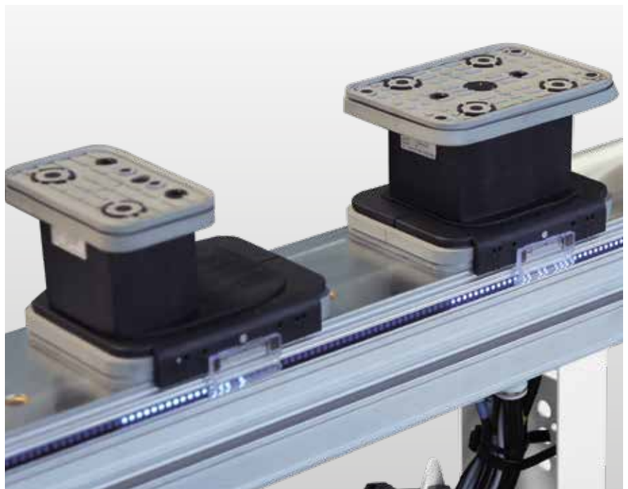
Sistema de posicionamiento LED (opcional) Una serie de luces LED indica al operario la posición, la alineación y el tamaño exactos de las ventosas, así como la posición de las consolas → Posicionamiento hasta un 70 % más rápido
