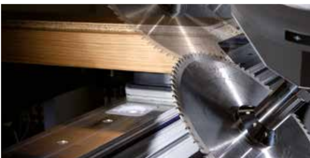
Cortes en inglete exactos y sin astillas
