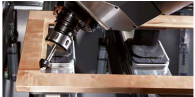
Recorte en ángulo de esquinas para los canales del cristal
