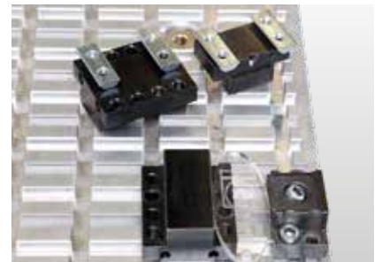
Mesa tramada de aluminio con ranuras trapezoidales para la fijación flexible y con arrastre de forma de medios de fijación de cualquier tipo
