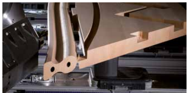
Perforaciones de piezas en ángulo cerrado
