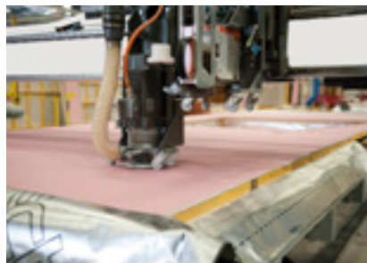
Bearbeiten von Gipskarton
